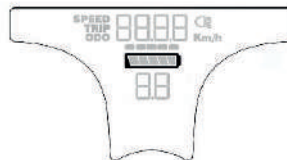
Meget lavt batteri niveau
