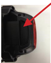
Håndtag til at skubbe/ trække batteriet ind/ud
