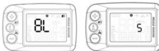
"BL"(backlight) står for baggrundsbelysning
