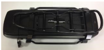
Batteriet er monteret på bagagebæreren
